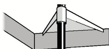
Posizionare il palo in riferimento al foro, disponendo il gradino di arrivo sul lato di uscita della scala.
