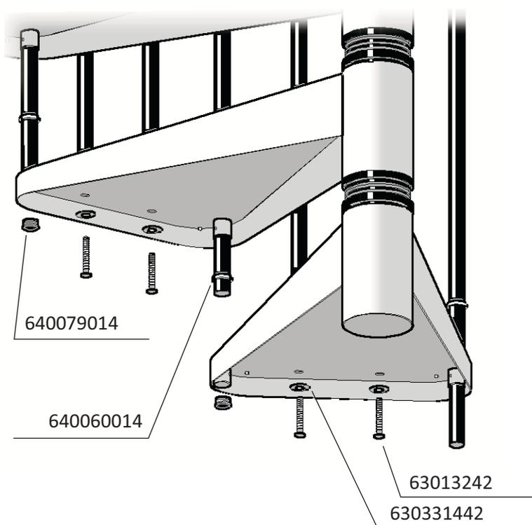
Inserire le colonne in tutti i gradini, bloccando quelle passanti con i grani e quelle sul gradino con la boccola ad espansione "Espa".
