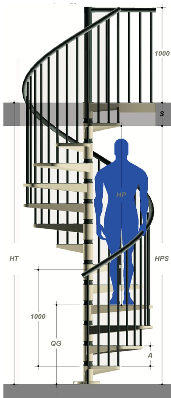
HT - Altezza totale da pavimento a pavimento (HPS+S)
